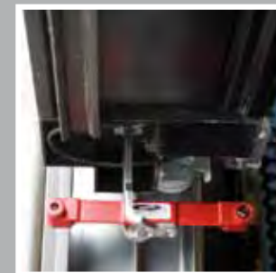
De 'Leading Safety Beam', een meelopende veiligheidsfotocel
